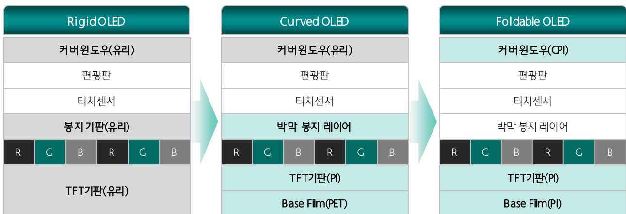
그림 2. OLED 모듈구조변화
