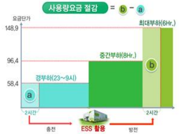
<그림 8> 에너지저장장치(ESS) 활용시 전기요금 절감 개요도
