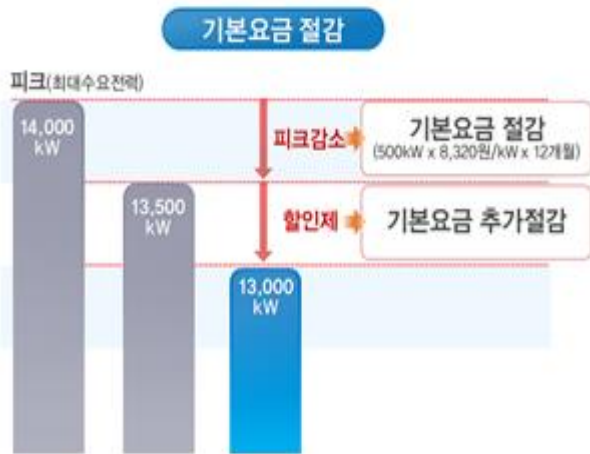
<그림 7> 에너지저장장치(ESS) 활용시 전기요금 절감 개요도
