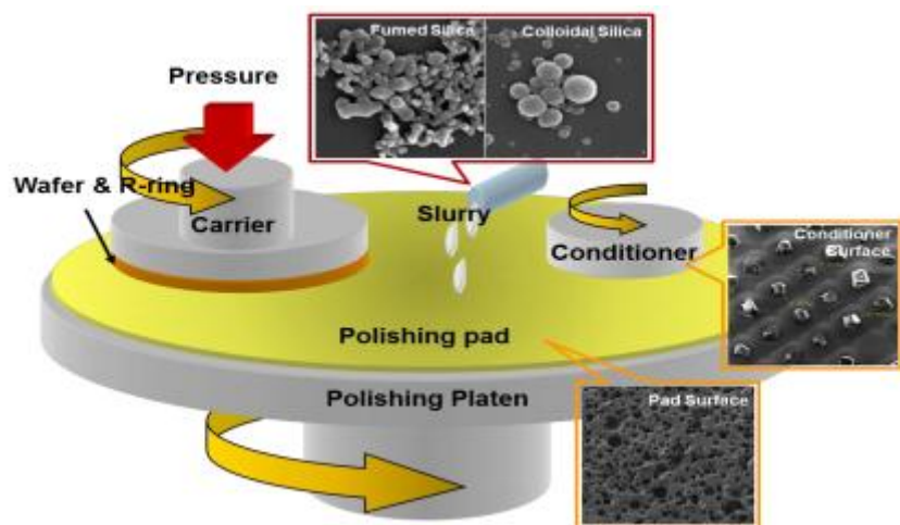
그림 8. CMP(Chemical Mechanical Polishing) 구성요소
