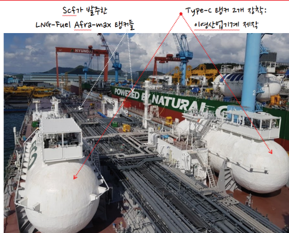
〈도표25〉 현대삼호중공업이 건조 중인 아프라막스탱커에 장착된 LNG-Fuel 탱커 (도표26) 현대중공업이 개발한 Scrubber와 실증 평가 설비
