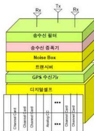
그림16 2G/3G 기지국(BTS) 구조 및 형상
