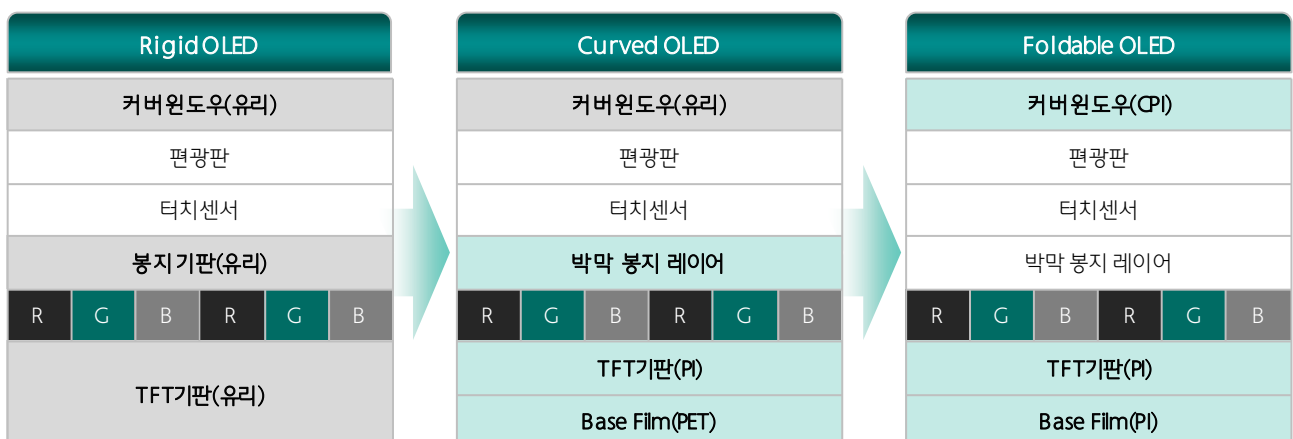
그림 5. OLED 모듈구조변화
