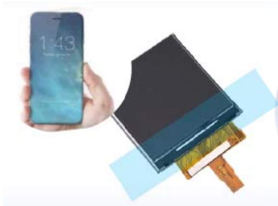
[그림 10] 디스플레이 패널 - 압흔검사 적용 부분
