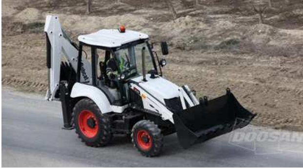
[그림 1] 백호로더 - 전방 로더, 후방 굴삭기
