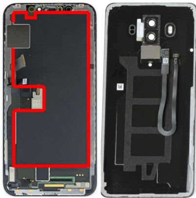
[그림 18] 방열시트 적용: 패널 후면(좌), 외장 케이스(우)
