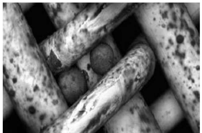
그림 10. Cat fines entrapped in the mesh of a fuel filter
