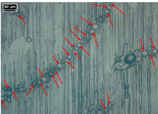
그림 9. Red arrows show cat fines embedded in cylinder liner
