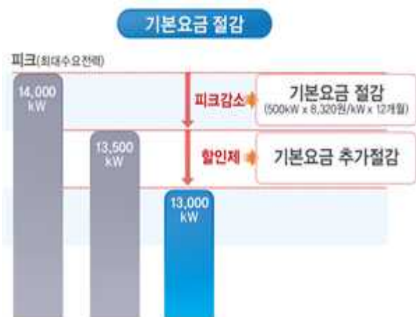
&lt;그림 5&gt; 에너지저장장치(ESS) 활용시 전기요금 절감 개요도
