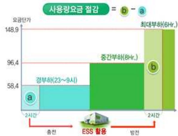
&lt;그림 6&gt; 에너지저장장치(ESS) 활용시 전기요금 절감 개요도
