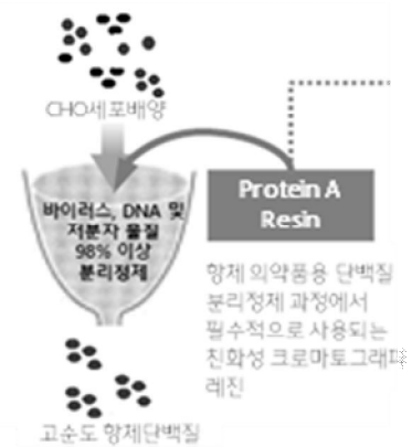
그림 5. Protein A 레진을 이용한 항체의약품 정제과정
