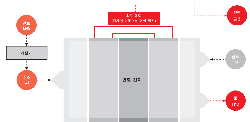
<그림39> 연료전지를 이용한 수소발전의 발전 방식 (PEMFC 기준)
